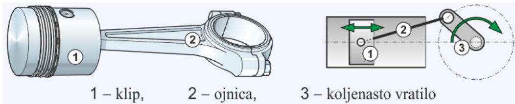
Slika 8.01 Klipni mehanizam
